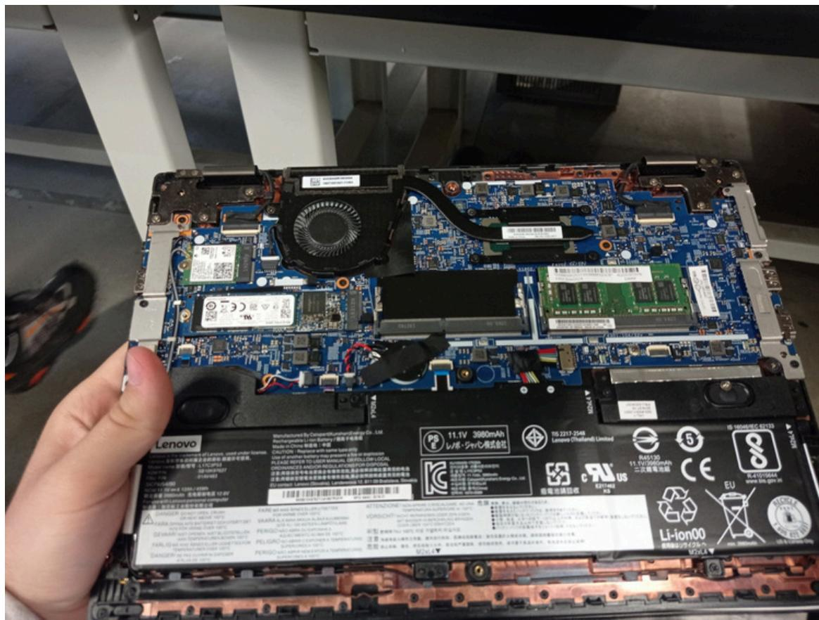
Une fois terminé il faut remettre le SSD dans le laptop démonté le remonté puis le mettre sur palette.
